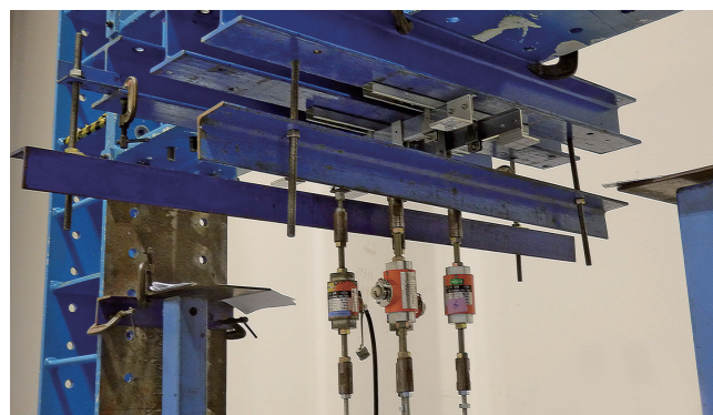
▲天井面法線方向試験
