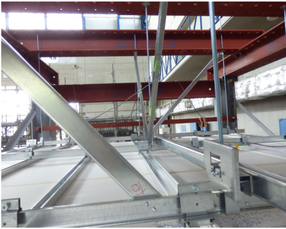
ブイ・プロ 25 (野縁受方向) 加振実験結果
